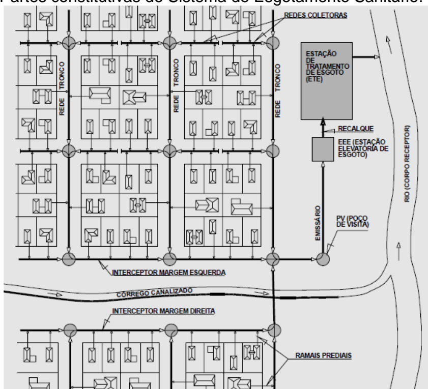
Figura 39 – Partes constitutivas do Sistema de Esgotamento Sanitário.
