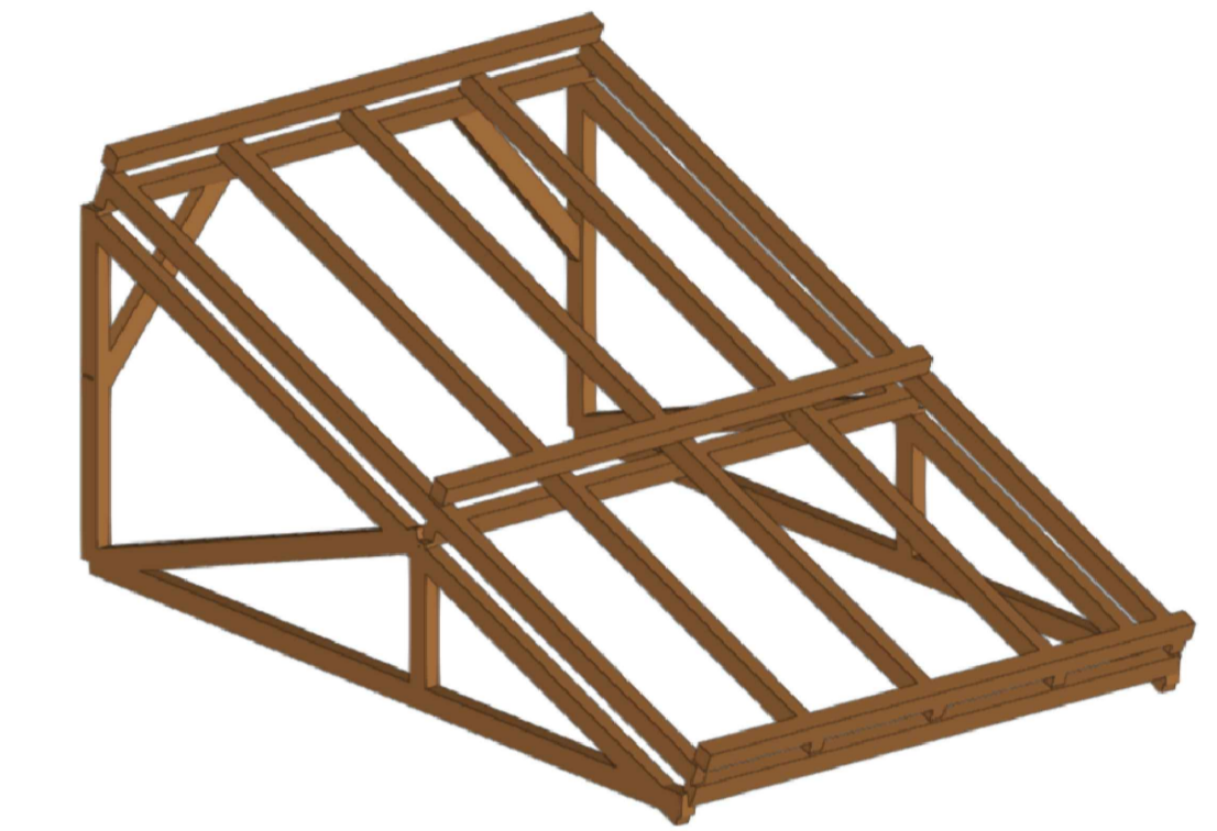
REMOÇÃO DAS RIPAS E INSTALAÇÃO DE NOVAS TERÇAS
