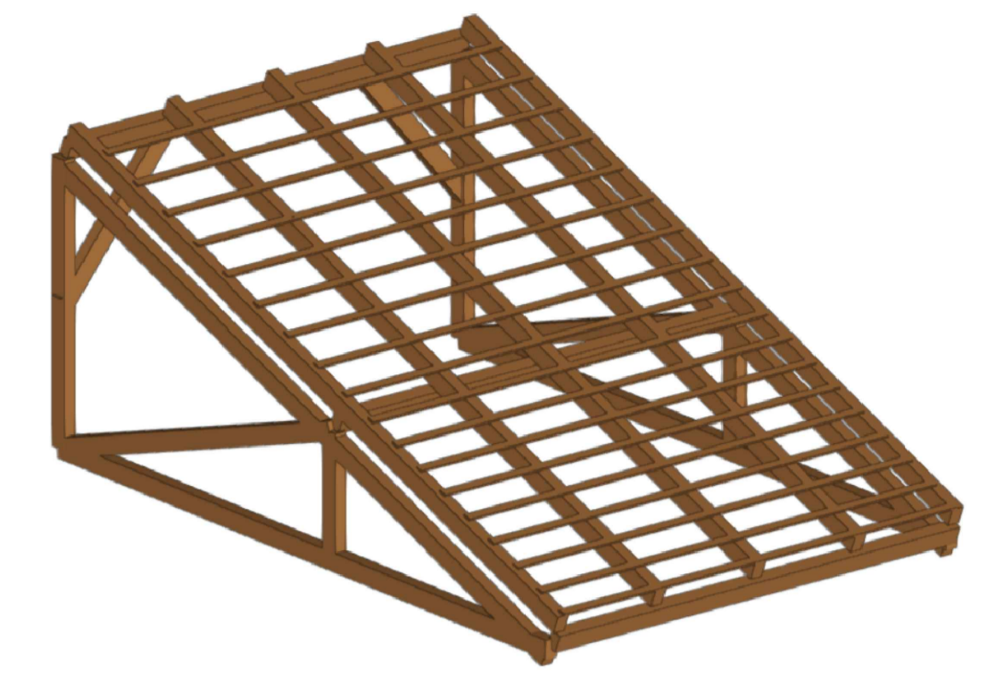
SITUAÇÃO ATUAL, COM RIPAS PARA TELHAS CERÂMICAS
