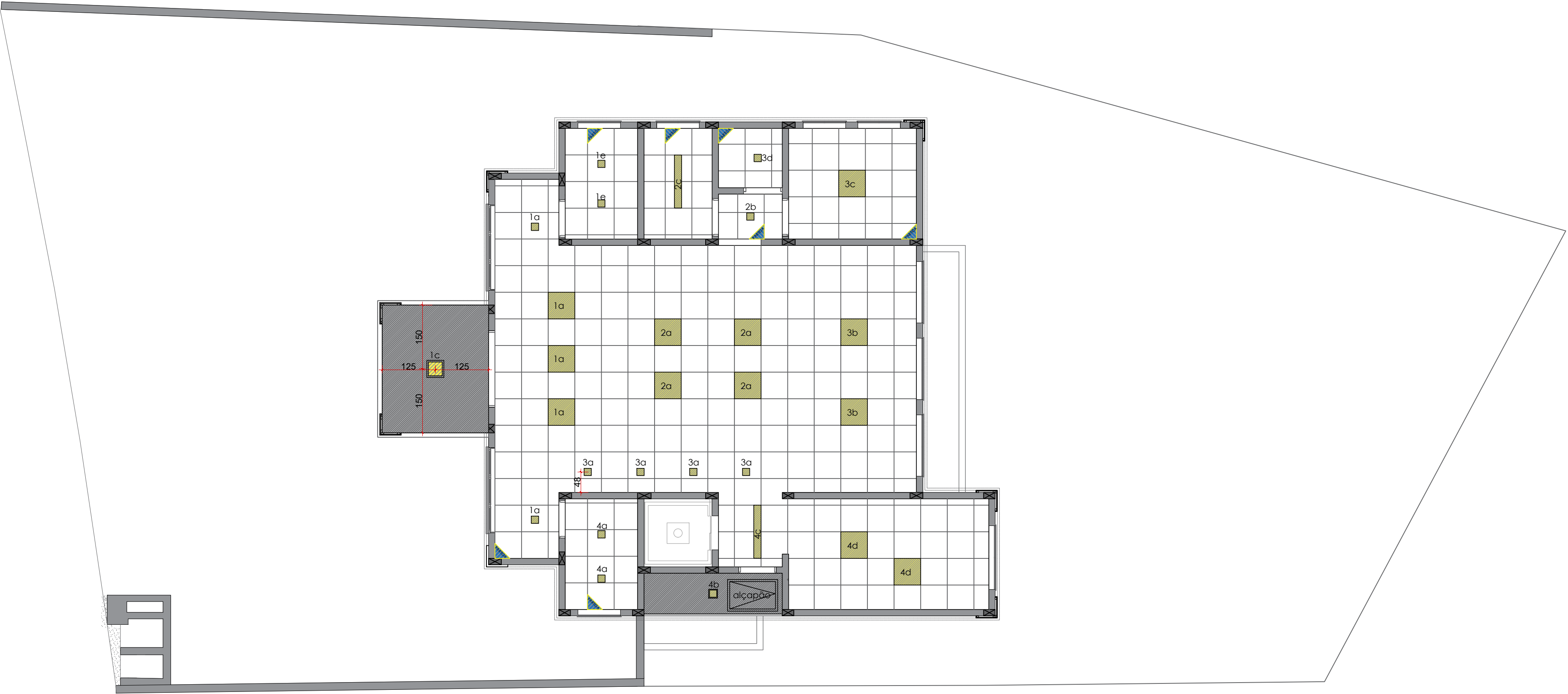
PLANTA TÉRREO - FORRO E LUMINÁRIAS ESC. 1:75
